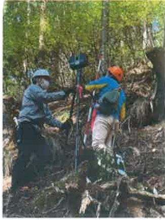
写真1：地上レーザ測量
